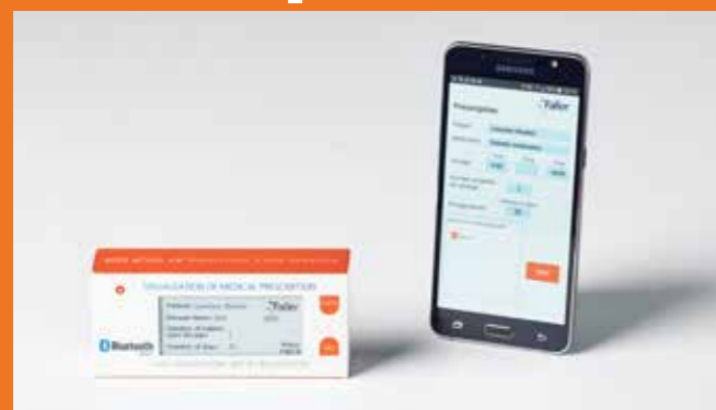
Die innovative Medikamentenverpackung „Medical Prescription“ mit E-Paper-Display und Bedientasten zählt Tabletten und erinnert an die pünktliche Medikamenteneinnahme. Eine eigens entwickelte App überträgt via Bluetooth die Einnahmeverordnung an die digitalisierte Faltschachtel.
