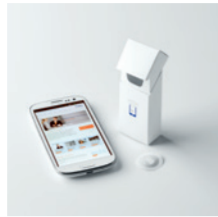
Faltschachtel mit NFC-Chip: Pharmazeutische Sekundärverpackungen lassen sich mit einfachen QR-Codes oder der erwähnten NFC-Technologie ausstatten, die per direktem Smartphone-Link eine Verbindung zum Internet schafft.
